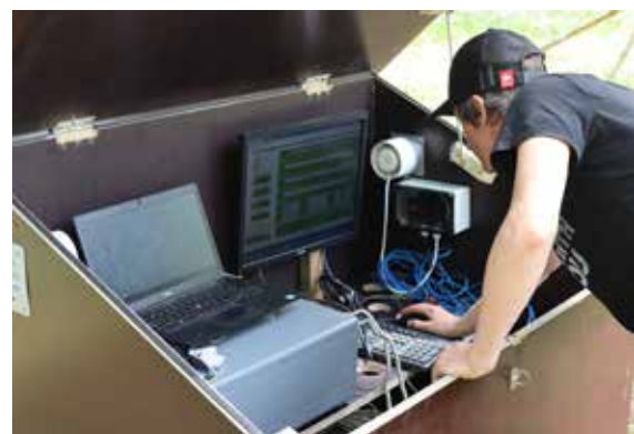
Computeren samler dataene, og her kan Jesper Riis Christiansen blandt andet se kurver over udledningen af forskellige klimagasser.
