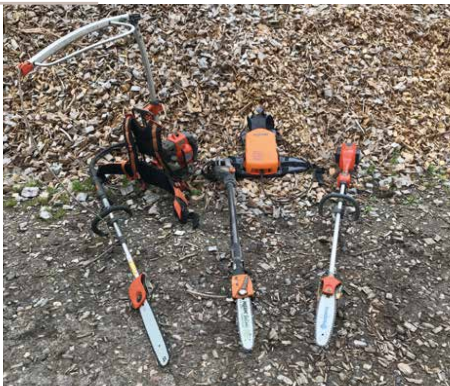
De tre afprøvede udrensningssave. Fra venstre ses benzindrevet rydningsssav fra Husqvarna 535 FB, i midten er det en elektrisk teleskopstangsav fra Pellenc og til højre ses elektrisk rydningsssav fra Husqvarna 536 LiPX.
