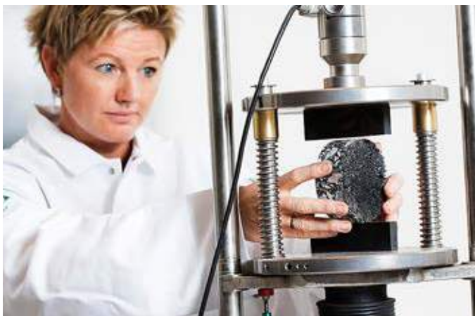
De tekniske egenskaber ved bioasfalt er på flere punkter bedre end bitumen-asfalt. Her testes en prøve på Peabs laboratorium.
