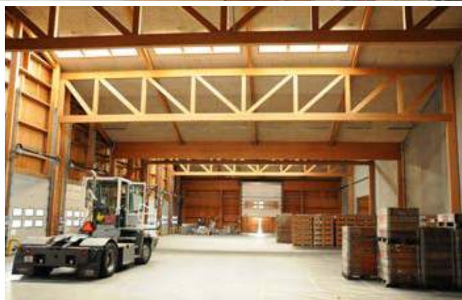
De bærende konstruktioner er traditionelle limtræsuer og gitterspær.
