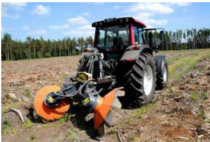
Før plantning blev der lavet oprilning med denne dobbeltpløj fra Letland.
