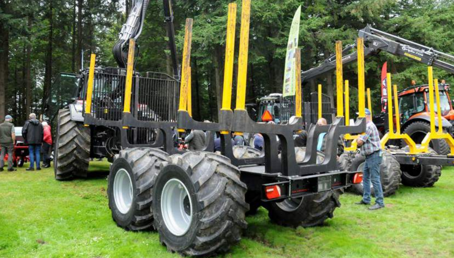
Valtra traktor med Kronos 16 tons vogn der er monteret direkte på traktorens bagtøj.
