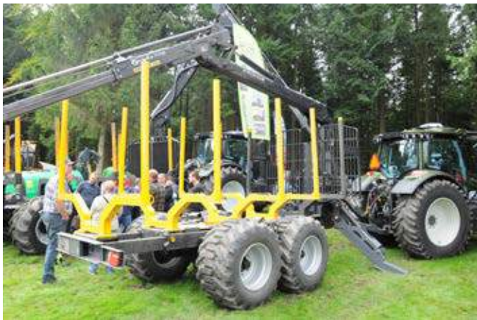
Valtra traktor med Kronos 12 tons vogn med semiautomatiske støtteben.
