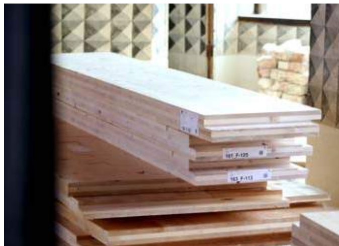
CLT brædder består af mange lag træ der er limet sammen.
