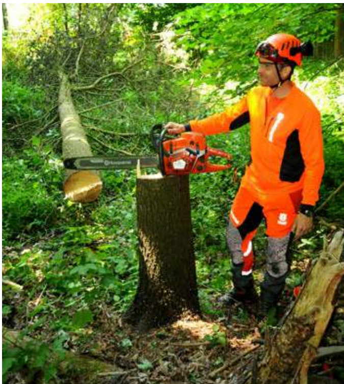
Saven blev demonstreret ved fældning af en stor fyr. (Stødet er meget højt for at undgå at træet falder ned i hegnet).
