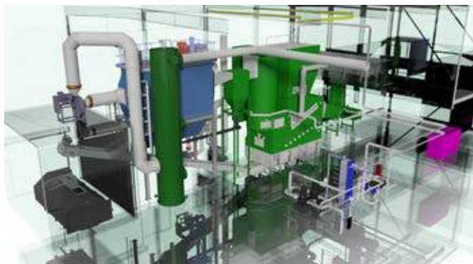
Det nye anlæg til flisfyring med en effekt på 5,5 MW. Flisen leveres af et lokalt skovbrug, Øland Skov, 5 km fra Brovst.
