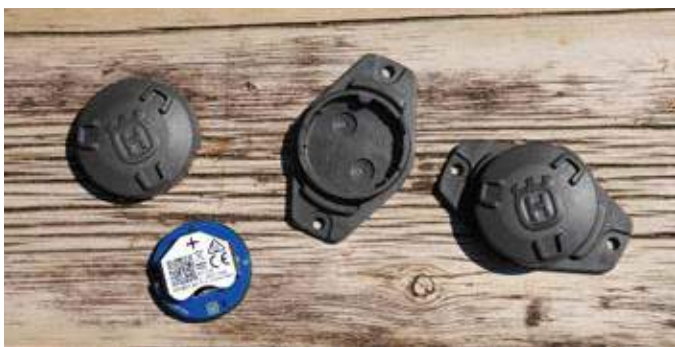
Sensoren som monteres inde i motorhuset. QR koden aflæses af mobilen som så henter data om savens brug med bluetooth. Data lægges ind i computeren som led i overvågning af savens brug.
