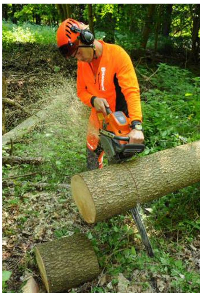
En ny barkstøtte og en kraftig motor gør at den skærer hurtigt gennem stammen. Her med et 28" (70 cm) sværd.
