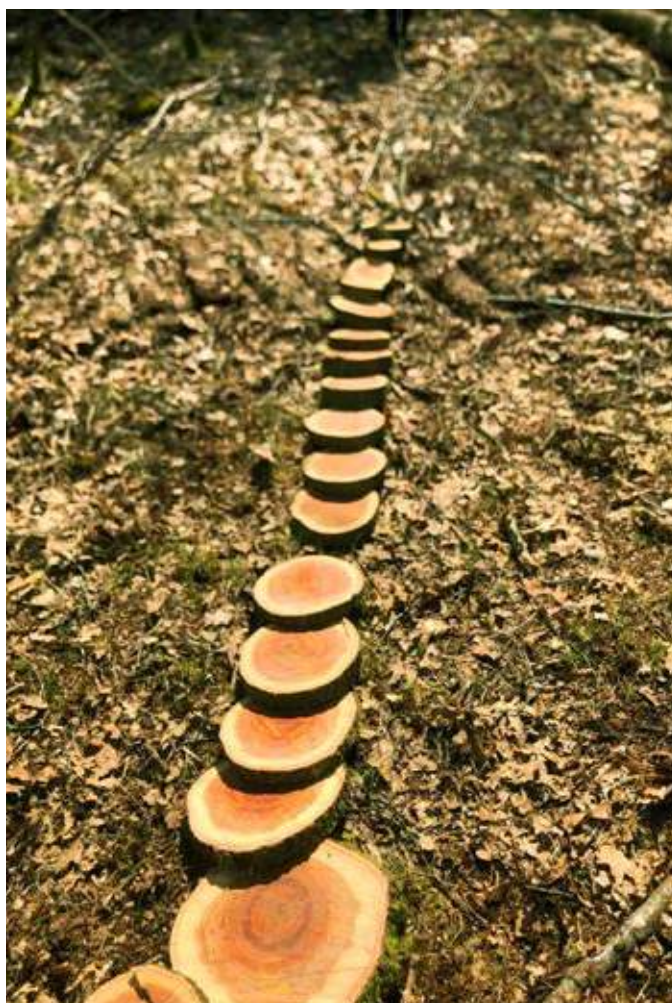
Foto 2. Højdevæksten i fire bevoksninger er opmålt ved udskeering af stammeskiver, her fra Fejsø.
