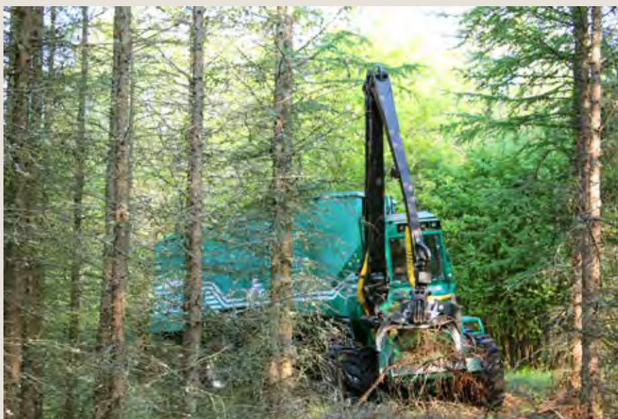
Bestandsgående flishuggere er meget anvendt i danske skove med ret korte afstande til bilfast vej.
