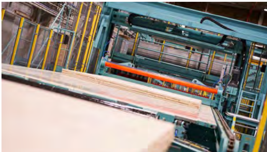
Presseanlæg til produktion af krydslamineret træ der kan forarbejdes til byggelementer.
