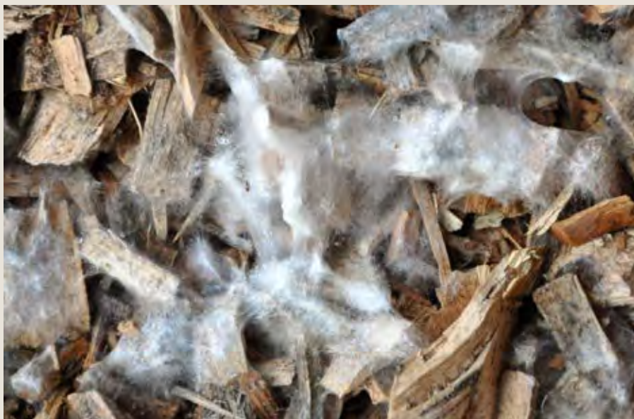
Foto 1. Man kan ikke altid se svampene, der vokser på flispartiklerne. I dette tilfælde er væksten så kraftig, at svampens hyfer er synlige
