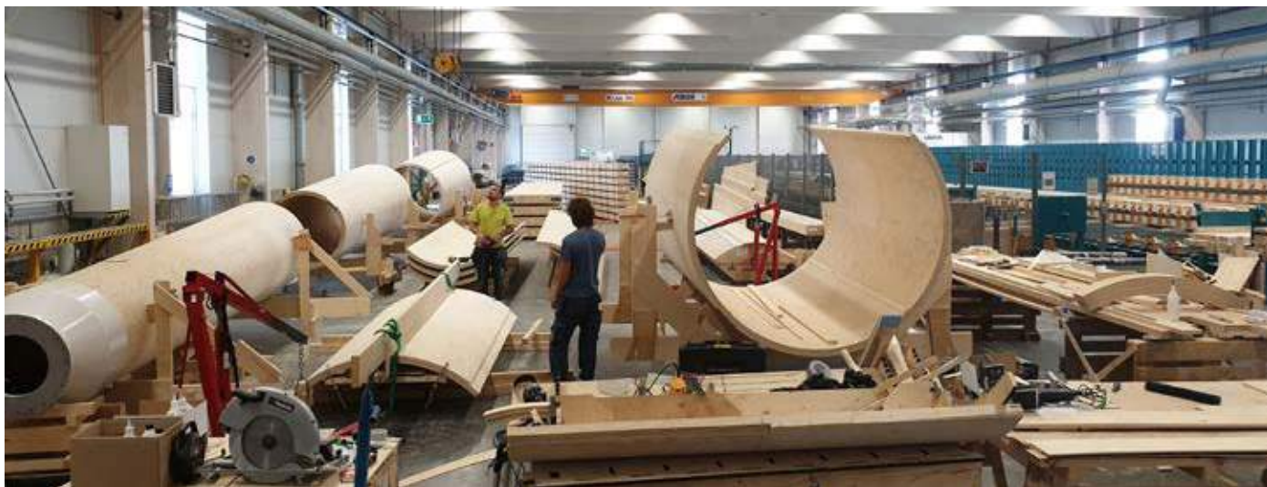
Trætårnet fremstilles i mange dele som kan samles på stedet, hvor vindmøllen opføres.
