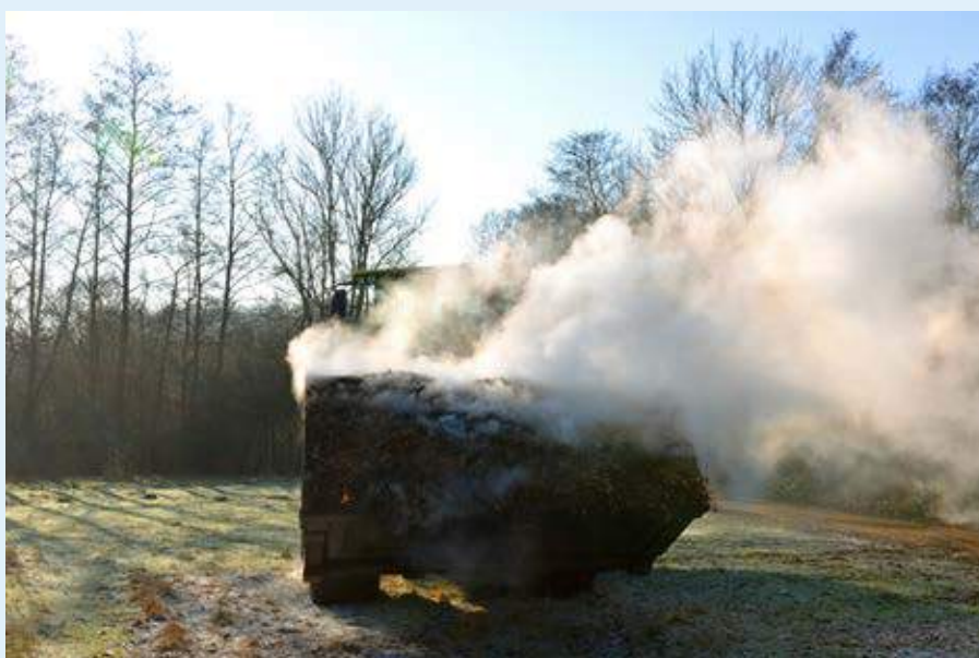
En gummiged er det bedste "værktøj" til håndtering af selvantændelsesbrande i flis. De varme lommer skal findes og fjernes, og resten af stakken skal luftes ud, så der ikke opstår nye brande. Hav stor fokus på at der ikke går ild i gummigeden under det vanskelige arbejde.
