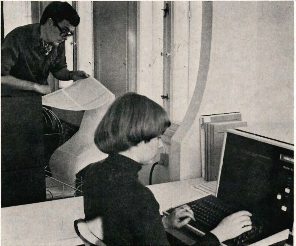
Indtastning af oplysninger via dataskærm. I baggrunden kontrol af afskrift fra linieskriver, som kan præstere 200 linjer pr. minut.
