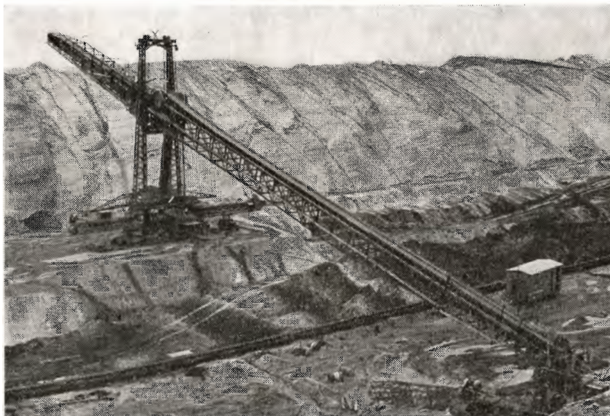
I de vældige brunkulslejer ved Søby produceres der endnu en del brunkul. I maj 1969 flyttede denne 120 meter lange transportør endnu overjord væk ned til 16-18 meters dybde (fot. maj 69).
