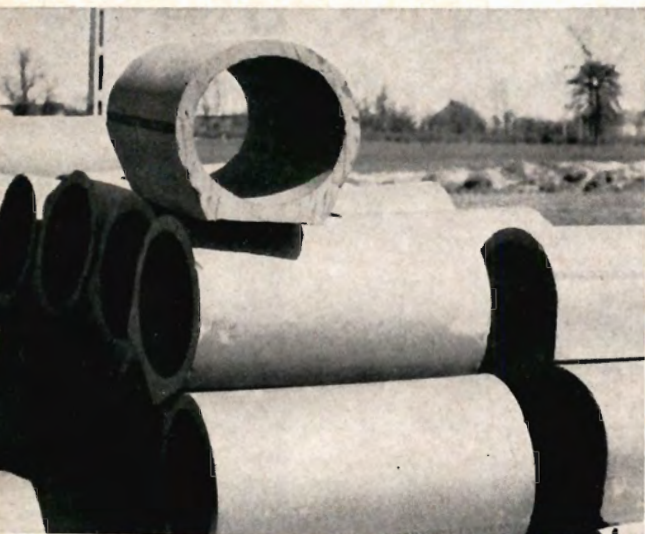
Anvendelse af polske lerrør med fod til hovedledning.
