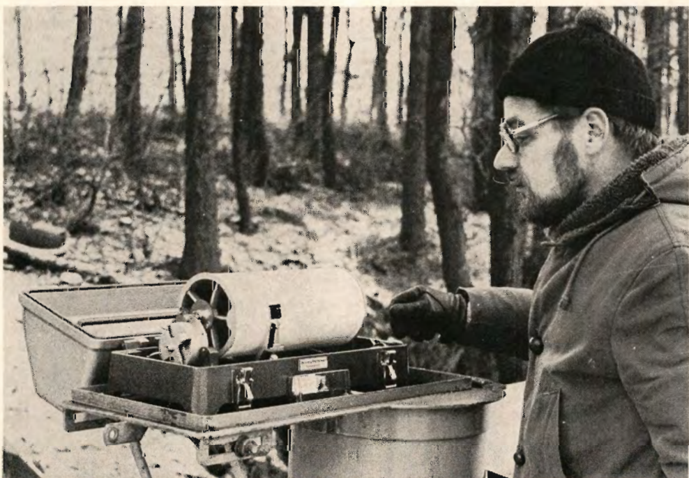
Hydrometriske Undersøgelers stationære vandstandsmåler til kontinuerlig registrering af vandføring.
