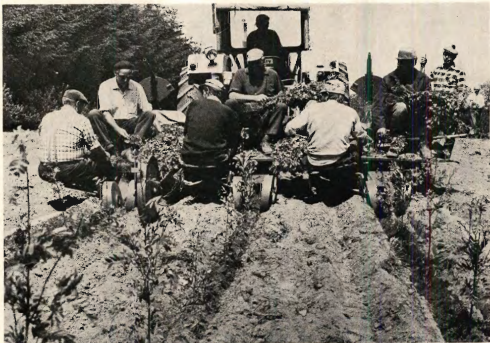
Trefuret Tolne-plantemaskine konstrueret til plantning af 3-rækkede læhegn. Kapacitet ca. 24.000 planter pr. dag.
