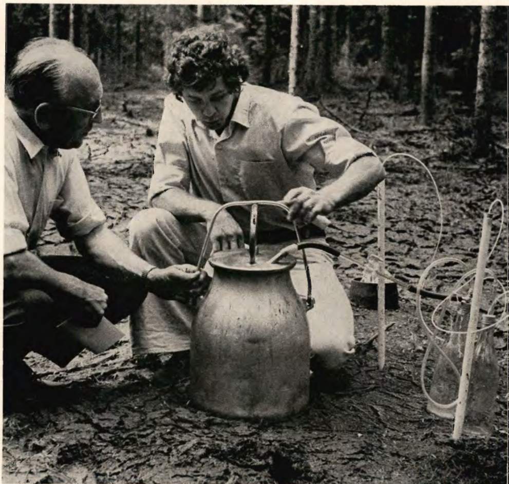
I forsøgene med slamdeponering i Hesselvig plantage udtages der vandprøver i forskellige dybder til kemisk analyse.
