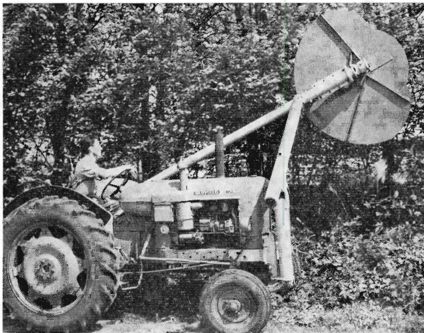
Figur 19. Traktormonteret hegnsklipper med roterende knive. Arbejdshøjde 6-8 meter.
