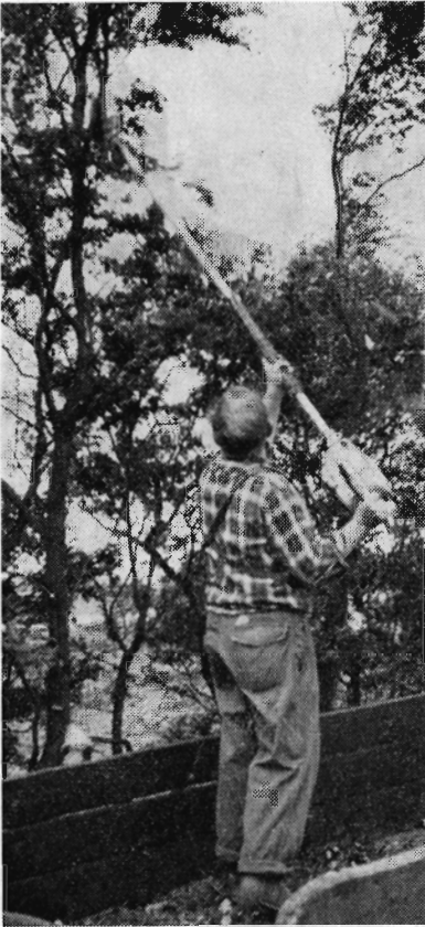
Figur 17. Buskrydder anvendt fra arbejdsvogn. — Beskæringsarbejdet kan udføres i indtil ca. 4 m højde.
