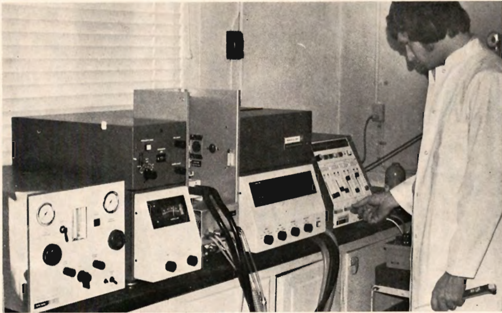
Laboratoriets nye atomabsorptionsflammespektrofotometer med grafitovnsatomizer monteret.
