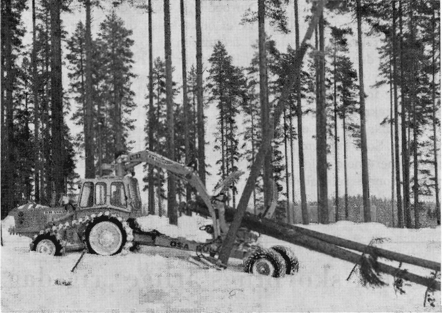
Volvo Nalle med Ösa-69 kran og Ösa apparatur til fældning og tilbygget anhænger med klemme-gaffel til at placere stammerne i for udslæbning.
