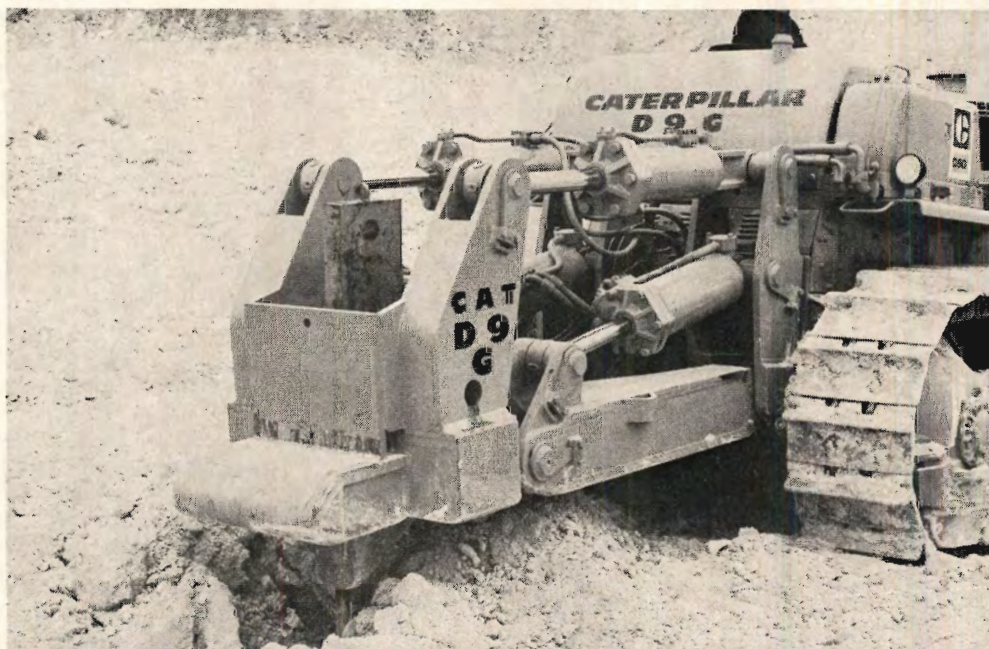
Oprivertanden i sænket position løsner kalken.
