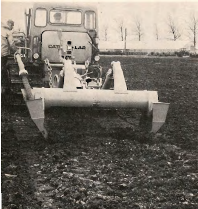
Willner drænmaskine i hævet og sænket stilling. Det V-formede skær løsner jorden over drænet. I den nedfældede position ses plastrøret blive ført ned i skærets venstre side.
