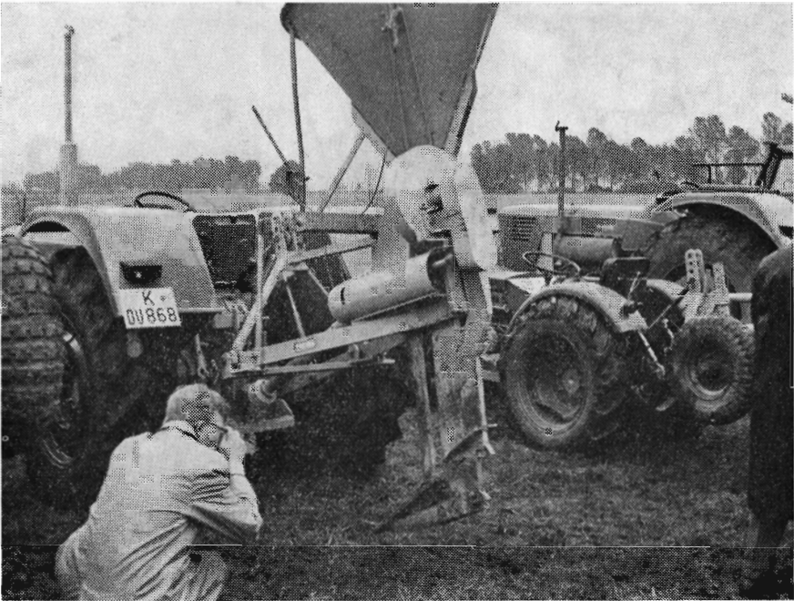
Fig. 5. Undergrundsøsner med bevægeligt skær. Apparatet til nedfældning af kunstgødning er påmonteret.
