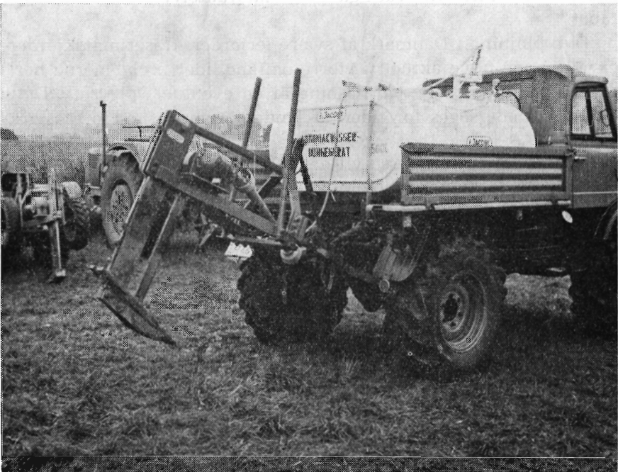
Fig. 6. Undergrundsøsner med bevægeligt skær og med apparatur til nedfældning af ammoniakvand.
