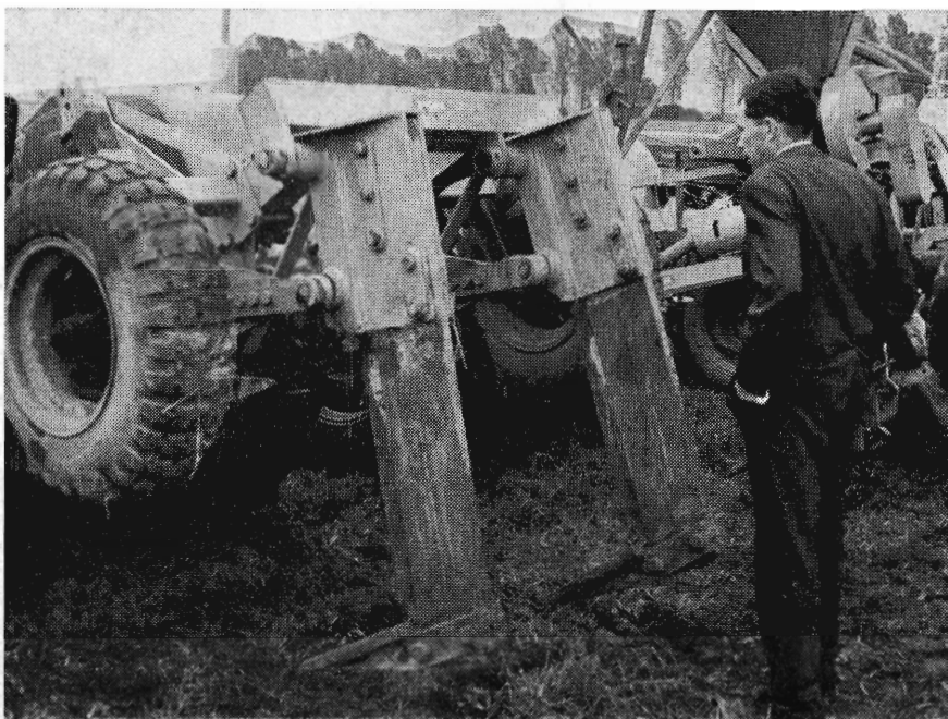
Fig. 3. Svær undergrunds løsner med bevægelige skær. Trækkes af en 110 hk traktor med 4-hjulstræk. Arbejdsdybde indtil 65 cm.
