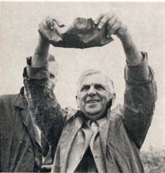
Konsulent Sv. A. Andersen konstaterer, at filtermaterialet er delvis stoppet af okker.
