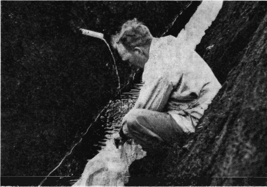
Måling af afstrømning i Lille Vildmose fra en 63 mm plastrørledning.
