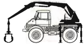
Unimog med kran — armen kan nå indtil 5 meter ud.
