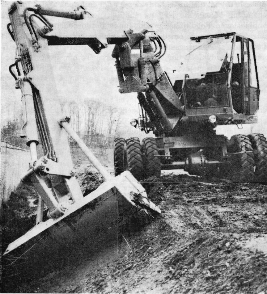
Salta-gravemaskine i virksomhed, hvor graveredskaberne udnyttes i en for maskinen særpræget vinkelstilling baseret på en drejekrans.
