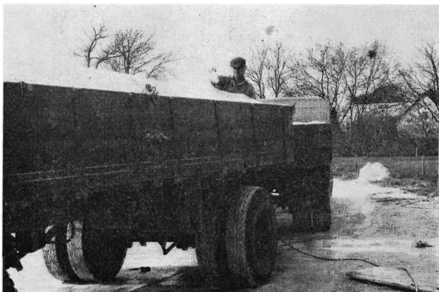
Kalklæsset oversprøjtes med vand i stedet for at dække det med presenning mod afblæsning under kørsel.
