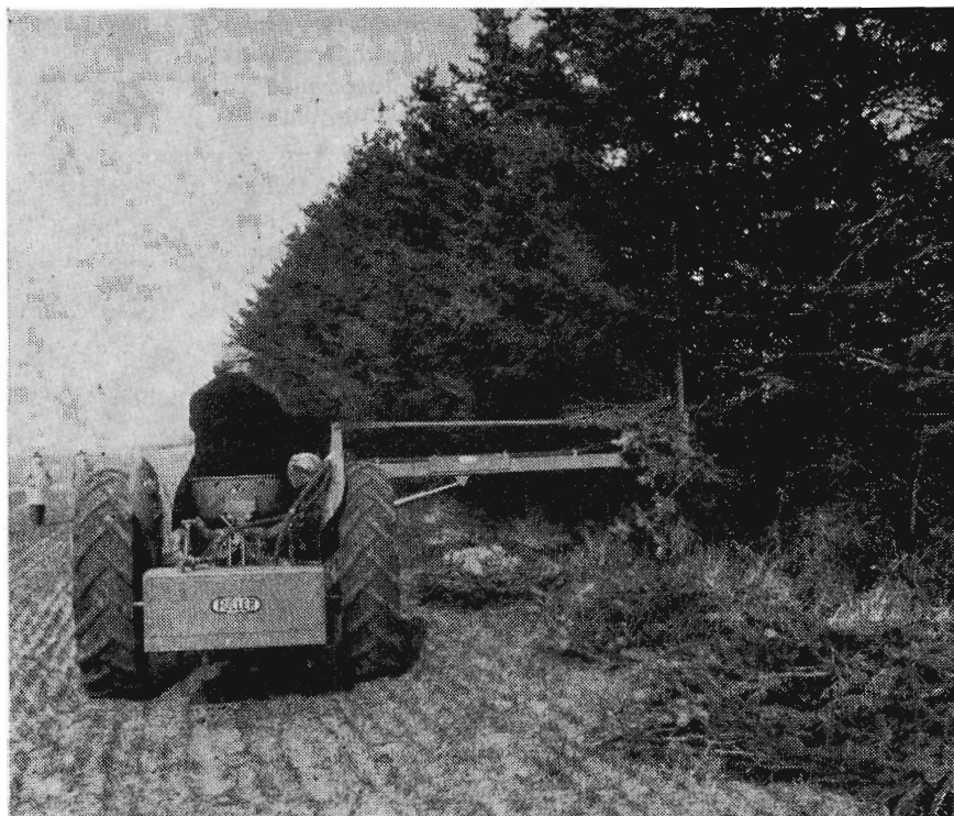
Den engelske hækkeklipper monteret hydraulisk på en traktor, således at traktorføreren samtidig med at køre fremad kan dirigere klippeaggregatet op og ned til enhver højde fra jordoverfladen og op til 5—6 meters højde.
