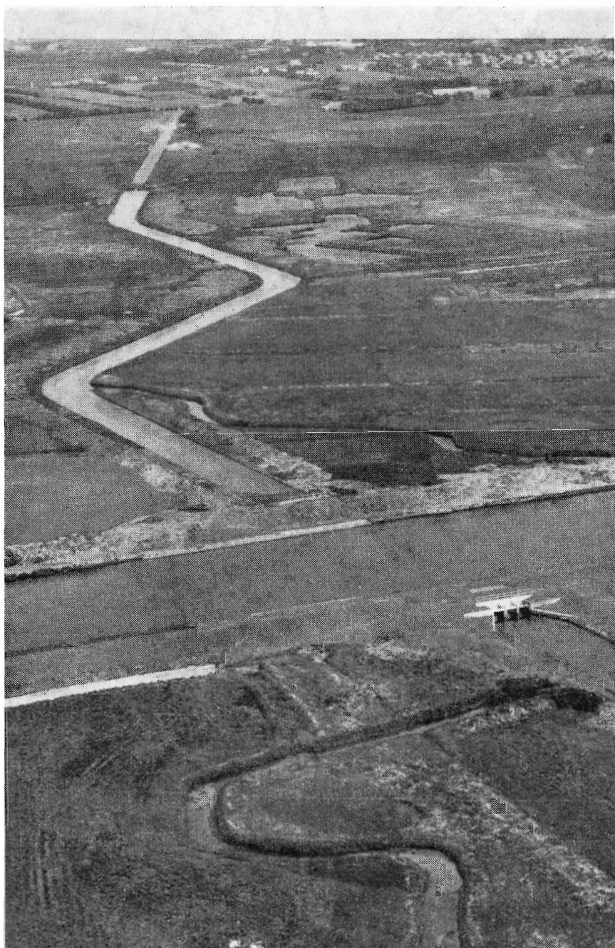
Nederst til højre løber Ganer å under det nye åløb og fortsætter syd på til det får afløb i den gamle Skjernå, der nu fungerer som parallelkanal. Midt i forgrunden nederst ses det gamle nu udtørrede Kirke åleje. Øverst Skjern by.
