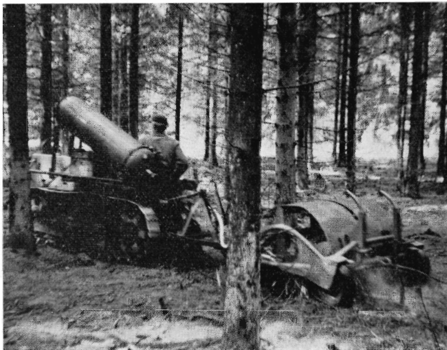
Fig. 1. Nedfældning af flydende ammoniak med Forstwalze trukket af larvefodstraktor. Grindsted plantage 1962.
