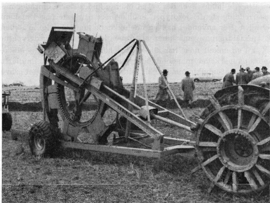
Svensk gravehjulsmaskine af let type, der kobles efter en almindelig traktor.
