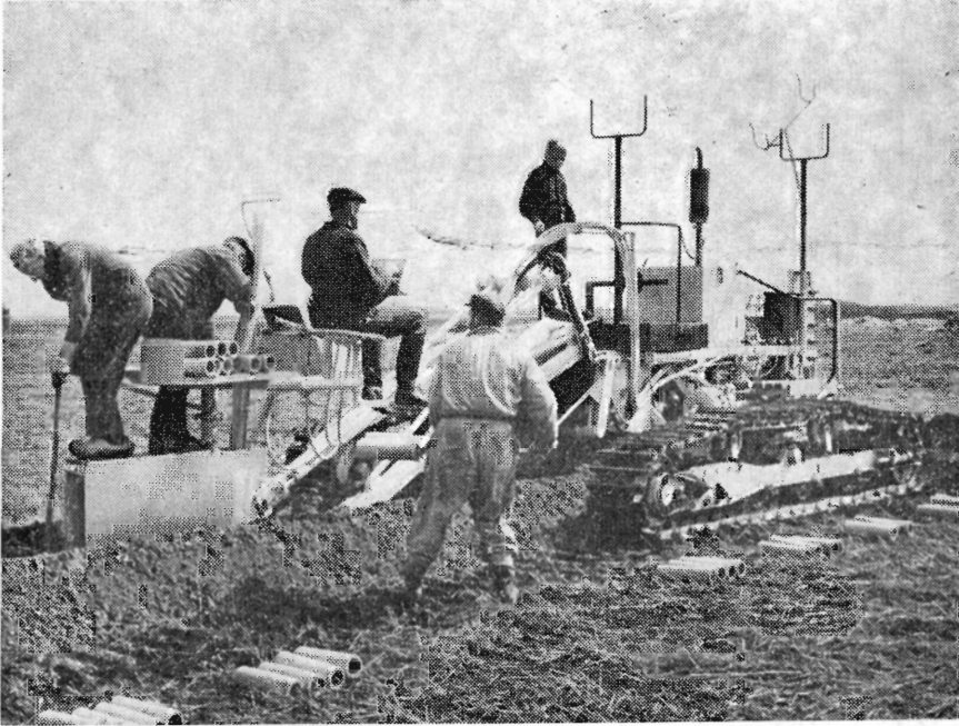
Fig. 2. Drængravemaskine I: Hurtiggående drængravemaskine, der er anvendelig på de lettere, stenfrie jordtyper.
