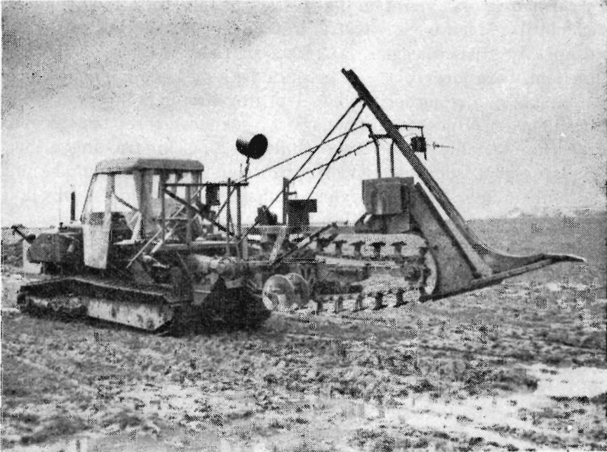
Fig. 1. Drængravemaskine II: Robust drængravemaskine, der specielt er konstrueret til gravning på svær jord.
