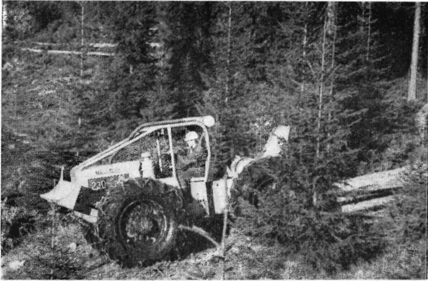
Udslæbning med »Timber Jack«.
