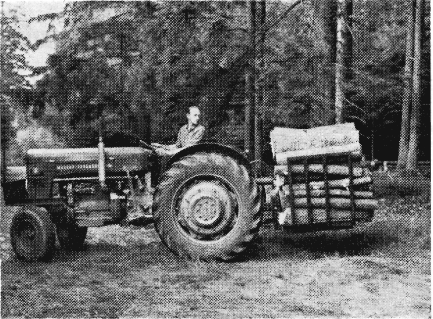
Udkørsel af træ med gaffel monteret på traktor.
