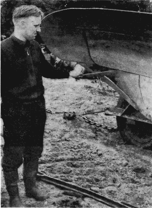
Hedeselskabets kæmpeplov fra maskincentralen i Klosterlund arbejder i forskellige udgaver, alt efter opgavens art, men fælles for dem alle er, at der slides på materiellet. På billedet ses, hvorledes den vædige muldplade er slidt i stykker under dybpløjningen i Sdr. Omme plantage.
