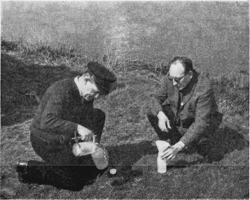
Fig. 1. Udtagning af vandprøver med filtrering på stedet.
