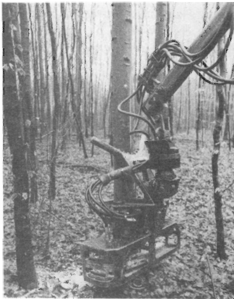
Figur 4. Hultdins fældegrab, model F 45, set bagfra under fældning. SI-foto.
