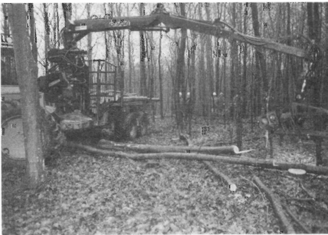
Figur 5. Hultdins fældegrab, model F 45, monteret på en Gremo TT 12 udkørselstraktor. Fældegrabben anvendes her til afkortning og læsning.
