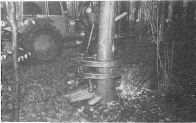
Figur 3. Hultdins fældegrab, model F 45, i færd med at fælde en ask. Bemærk fanggaffelen foroven og jernkassen med savsværd og oliemotor forneden. SI-foto.
