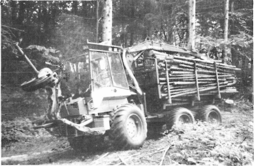
Figur 1. Gremo 603 udkørselstraktor. Bemærk Loft-udslæbningstangen i liften, som maskinen også kan anvende, når der køres „baglæns“.
