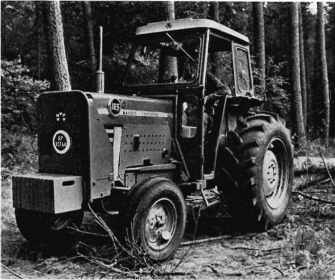
Fig. 6. Instituttets rådgivningsarbejde overfor skovbrugets maskinleverandører har medført nyudvikling, standardisering og seriefremstilling af bl. a. beskyttelsesudrustning til landbrugstraktorer, der skal anvendes i skoven.
