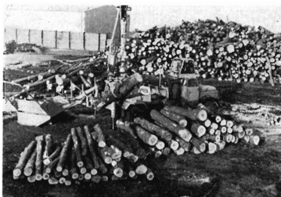
Fig. 1. I samarbejde med A/S Junckers Savværk og Östbergs Fabrik AB har instituttet udført forsøg med afkortning og sortering af 5,4 meter lange gulvtrækævler med Ösa-770 grabsav.
