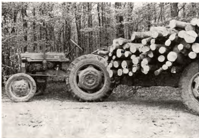
Figur 1. Lille landbrugstraktor med to-hjulet kærre til udkørsel af kemibrænde.
