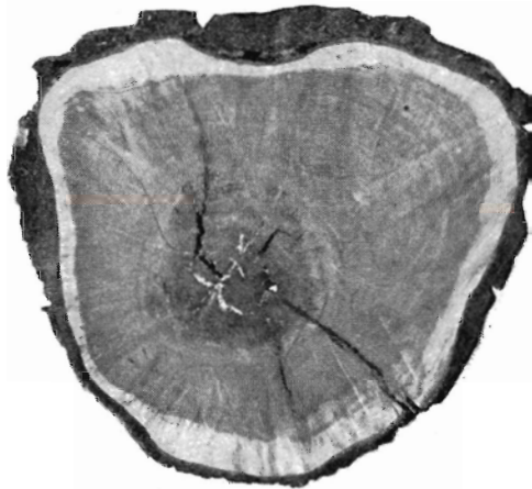
Fig. 1. Europæisk lærk ( Larix decidua ) med kærneråd forårsaget af blomkålsvampen ( Sparassis crispa ). Snittet lagt i 70 cm's højde. Største diameter under bark 1,03 m. Tinghus plantage 25.3.1968.
