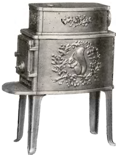
Fig. 8. Morsø Nr. 2 B. A. Højde 870 mm, Bredde 330 mm, Længde med Askeplade 700 mm, Fy- rets indvendige Længde 540 mm, opvarmer 75 m 3 . Pris 82 Kr.
