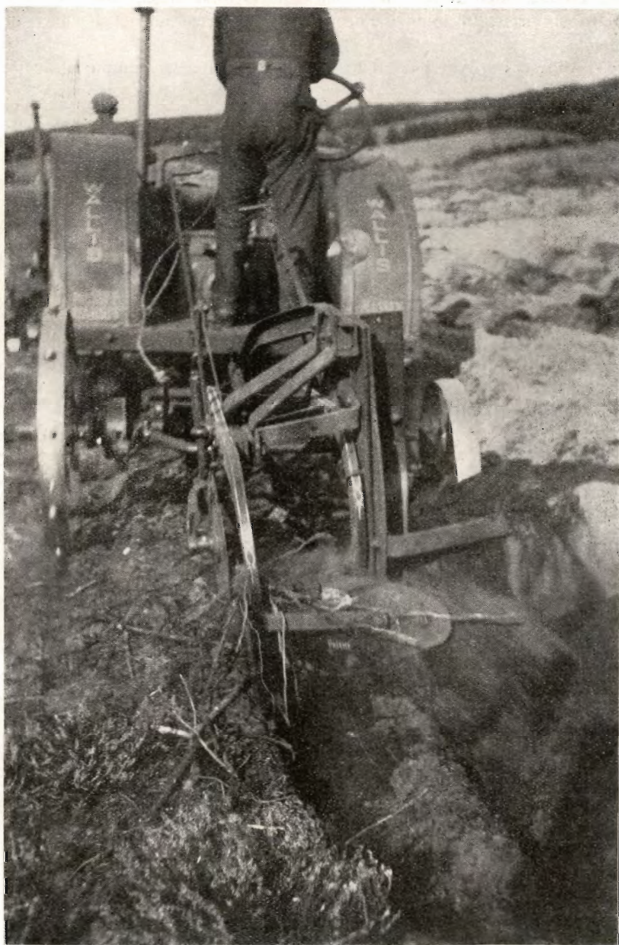
* Reolplov, trukket af 2 Traktorer, dybbehandler Jorden forud for Plantning.
