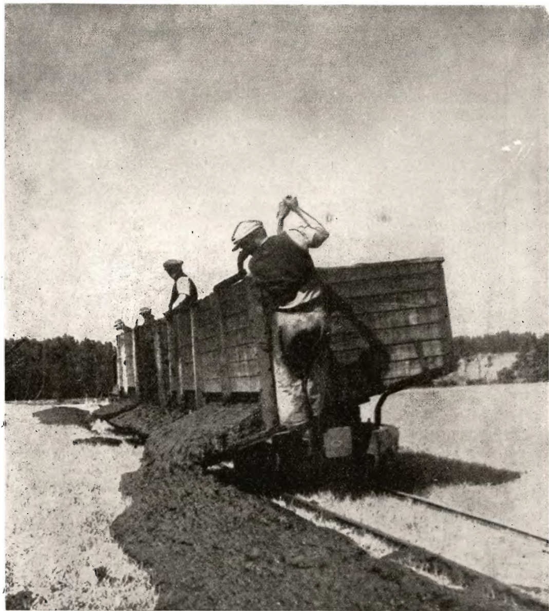
* Fra Ælteværket transporteres den nu vællingagtige Masse ud paa Læggepladsen, hvor Massen formes til Tørv.
