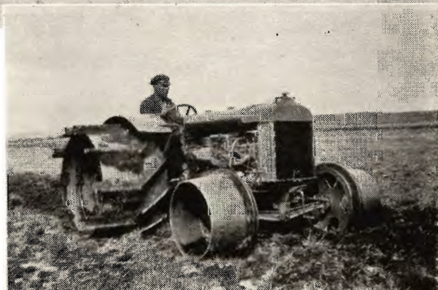
Øverst Fordson Traktor med Jordfræser og specielle Forhjul. Nederst Traktore i Arbejde for Hedeselskabet paa blød Mosejord.
