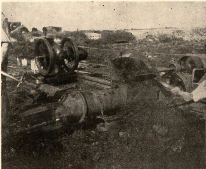
Fig. 18. Tørælteværk. Ælteakslen er forsynet med skruestillede Knive. Tørvmassen udpreses af en kort Snegl. Af den udpresede Tørvstreng afskæres Blokke med Materiale til 4—5 Tørv, som paa flade Vogne ud-køres paa Læggepladsen. Her opdeles Blokkene i enkelte Tørv.
