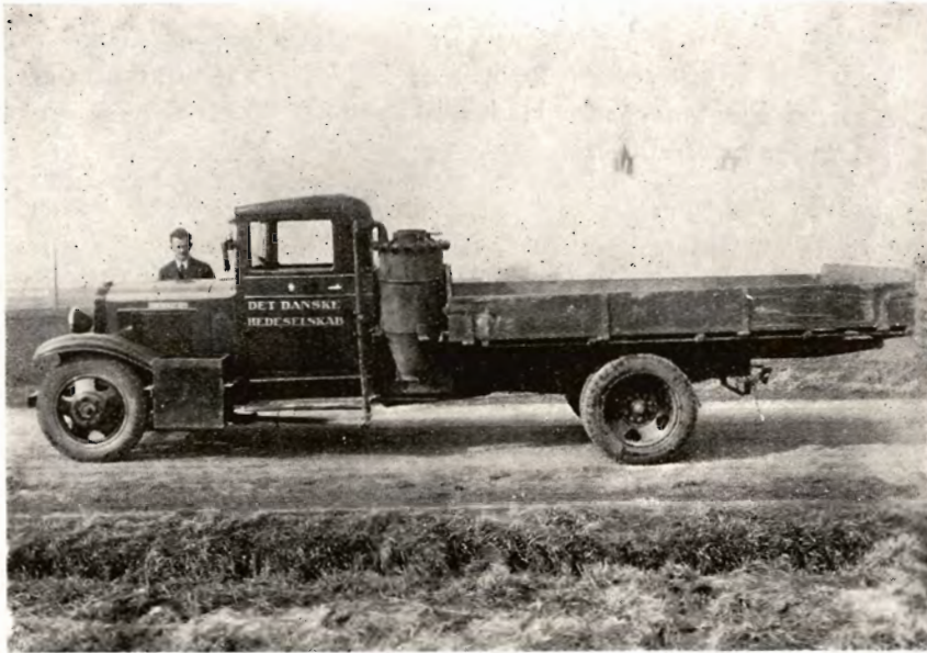
Allerede i 1932 kørte Hedeselskabet Forsøgskørsel med generatordreven Lastbil. Anlægget var et Compound Anlæg.
