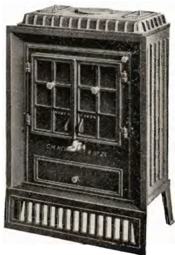
Fig. 9. Brændekaminindsats Nr. 25 fra C. M. Hess' Fabrikker. Højde 780 mm. Bredde 590 mm. Fyrets Bredde 380 mm. Opvarmer ca. 110 m 3 .
