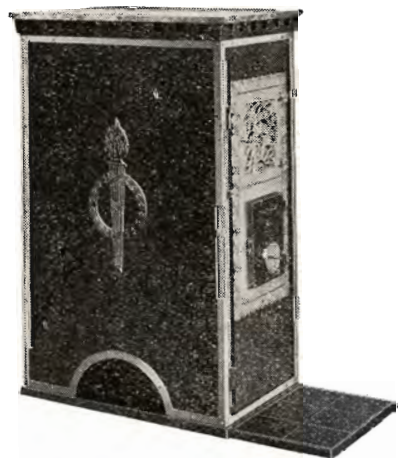
Fig. 5. Morsø Brændekamin Nr. 5 B til lige Væg. Med Kogerum. Højde 1240 mm. Dækpladens Bredde 820 mm. Fyrets indvendige Længde 630 mm. Fyrets Rumindhold 80 Liter. Varmeevne ca. 175 m 3 .
