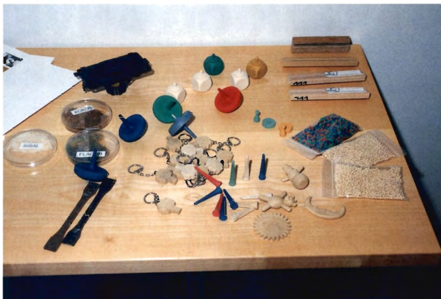
Foto 8. Eksempler på produkter lavet ved sprøjtstøbning. Der indgår 50% træ i form af flis og savsmuld, resten er majs og naturlige lime.
