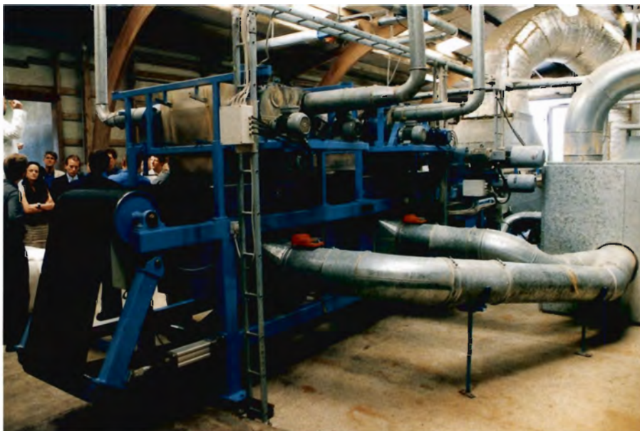
Foto 4-5. Produktion af en fibermåtte på laboratoriet i Tåstrup. Træfibre, termoplastiske fibre og lim blæses ud på en endeløs wire, opvarmes kortvarigt for at smelte plasticfibre, og den færdige måtte kommer ud i den anden ende (foto til højre). Maskinen er lavet til produktion af fibermateriale til bleer og hygiejnebind.
