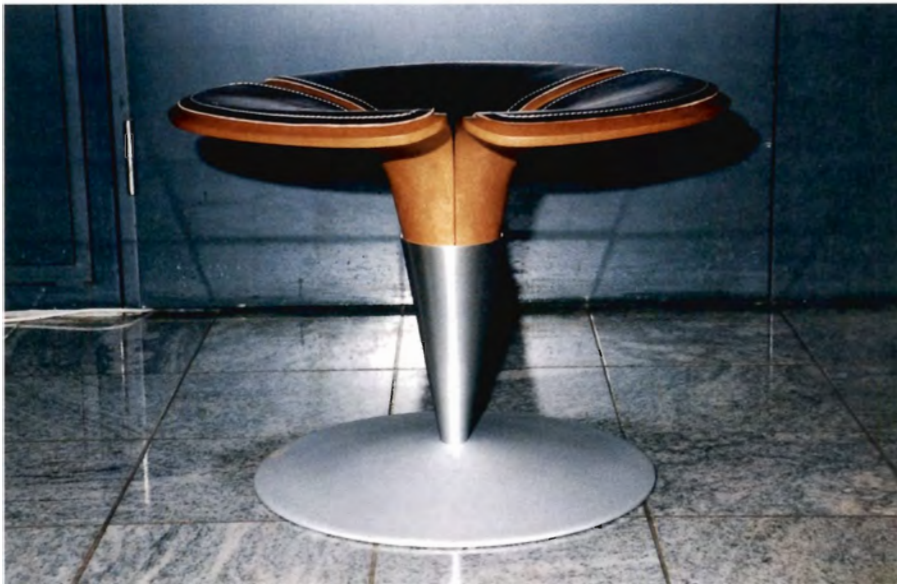
Foto 1. Taburet af træfiberskaller betrukket med læder, og med en drejefod af aluminium. Skallerne er lavet af 25 fibermåtter på hver 1,5 cm tykkelse - måtterne består af 80% granfibre, 10% plasticfibre og 10% fenol-lim. Pladerne anbringes i en presseform hvor de sættes under et tryk på 50 tons, og opvarmes i 10 minutter til 180 gr.
