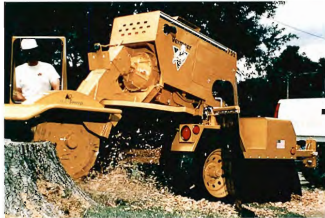
Vermeer SC752i stubfræser kan skære 64 cm i dybden.
