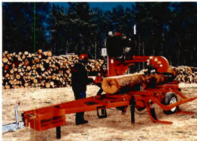
Den nye model af Wood-Mizer kan bl.a. opskære krogede stammer med indre spændinger.
