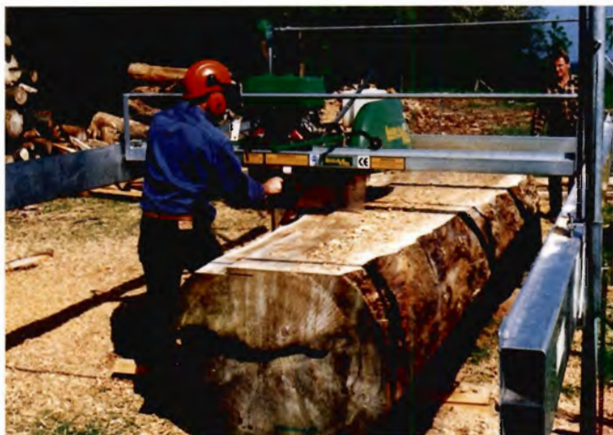
Lucas Mill savværk opskærer stammer på op til 1,8 m diameter
