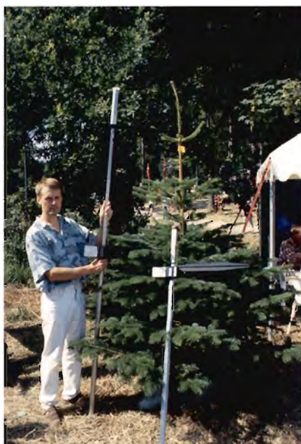
Datastangen vises her til højdemåling af et juletræ.
