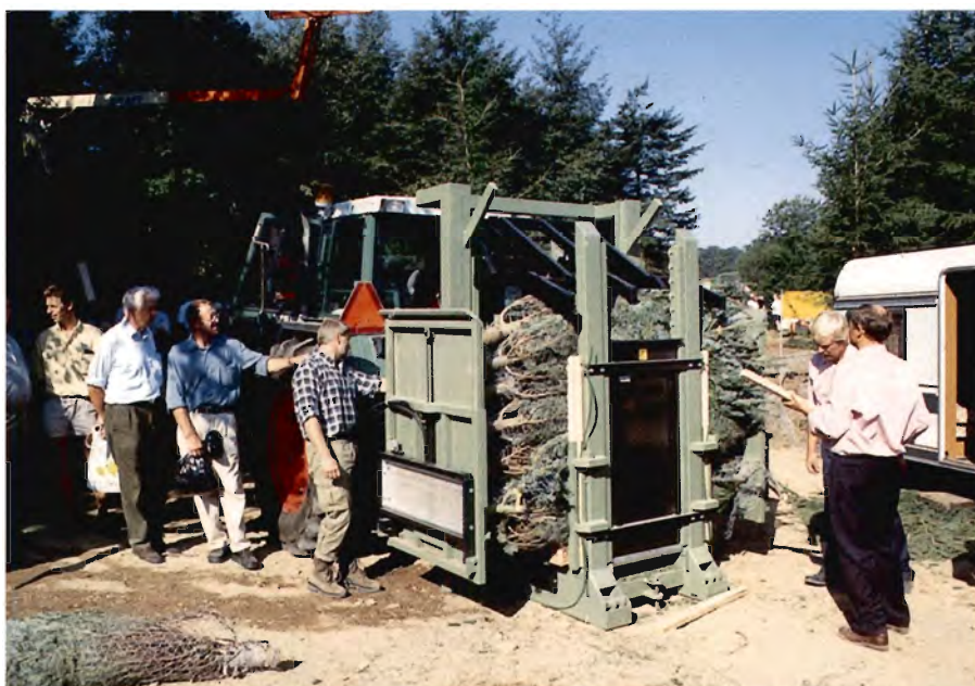
PSI-16 Pallepakker som pakker og komprimerer juletræer på en Euro palle - træerne fastholdes af et plasticbånd der går rundt om træer og palle.
