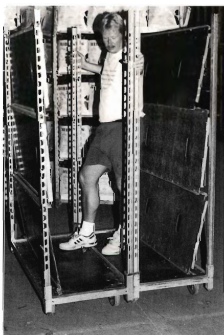
1. CC-container, der uden komprimering rummer 400-450 kg klippegrønt.
