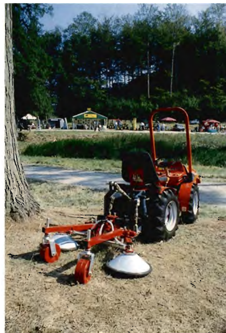
Prototype på en selvkørende maskine til afskærmet sprøjtning som kan sprøjte i rækkerne.
