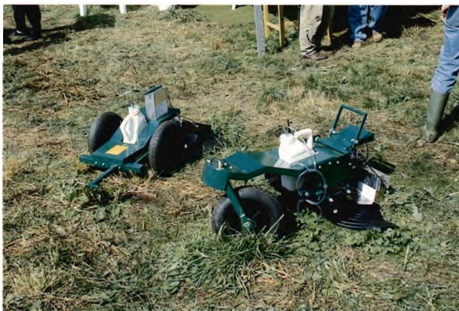
Nyudviklede Mankar sprøjter til afskærmet sprøjtning, forhandlet af T. H. Thomsen. De monteres foran eller bagved en havetræser eller minitraktor.
