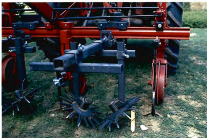
Radrenser fra det tyske Kress. Der er to tallerkener hvorpå er monteret fingre i en blød gummikvalitet som kan bearbejde jorden tæt på planten.
