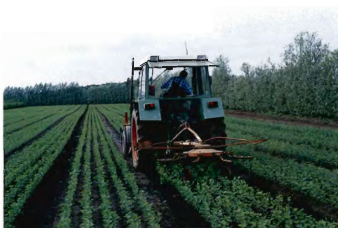
Rotorstrigle til renholdelse i en kultur af blærespiræa ( Physocarpus opulifolius - en busk der anvendes til læhegn mv.). Traktoren kører med en hastighed af 3-4 km/time, og rotoren kører med samme hastighed. (Fra Hedeselskabets planteskole).
