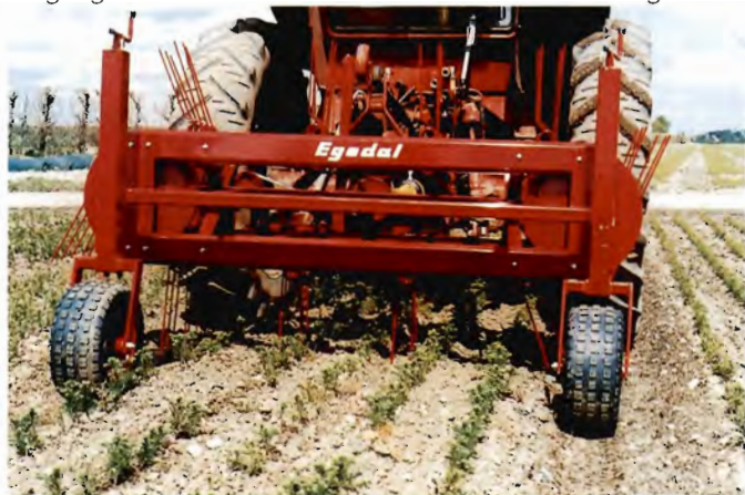
Tværstrigle fra Egedal. Den kan bruges i kombination med en langfingerharve som behandler i traktorens køreretning.
