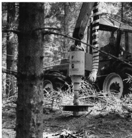
Figur 4. Hedeselskabet demonstrerer deres kranmonterede plantebor beregnet til kulturetablering under skærm.
