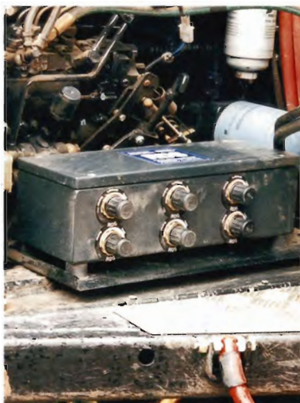
Fra en let tilgængelig boks, der er placeret i motorrummet kan dæktrykket forudindstilles til tre forskellige niveauer.
