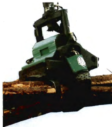
Figur 2. Pika harvestergrapple kan monteres på en udkørselsmaskine og udføre både skovning og læsning.
