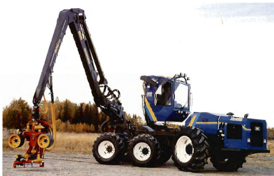
Figur 1. Pendo EVA er udstyret med pendlende førerhus.
