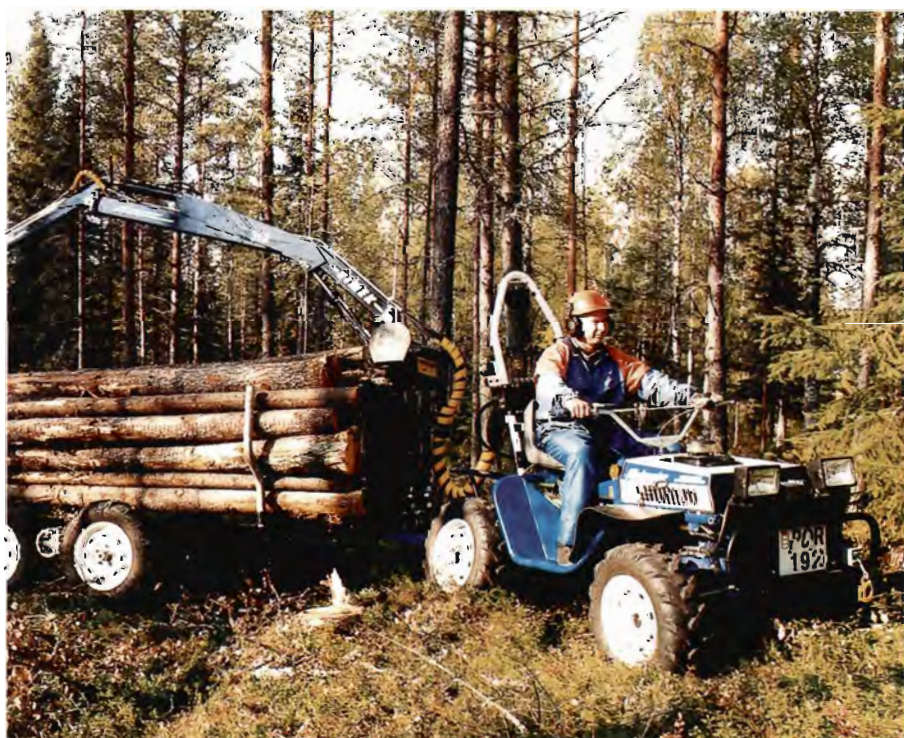
Figur 6. Vimek Minimaster 101 er udstyret med pto og hydraulik. Den kan desuden forsynes med tre-punkts lift.
