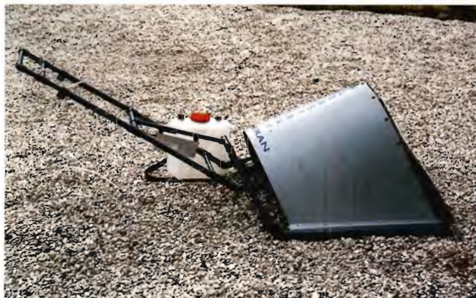
Foto 1. Flexspray-sprøjtten som har variabel spredbredde fra 90 - 140 cm.
