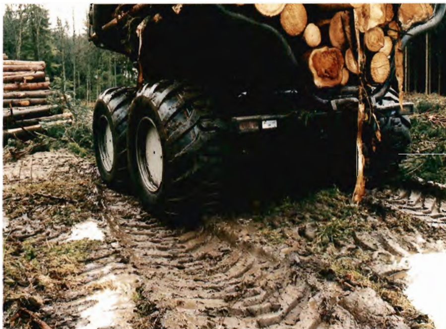
Et lavt marktryk giver færre skader på jorden og dermed på træernes rødder, især på en våd og leret jord.
