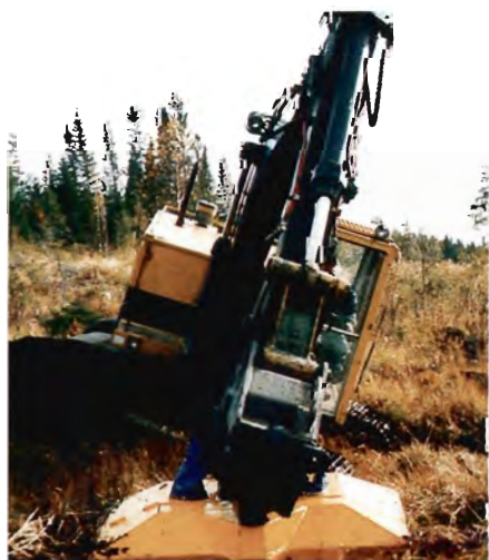
Figur 5. Swe Plant System er monteret på en gravemaskine. Planteaggregatet holdes automatisk vandret.
