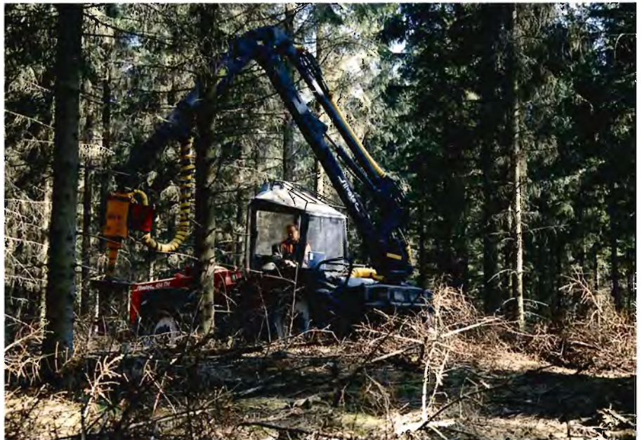
Figur 1. Hedeselskabets nye redskab til jordbearbejdning, monteret i spidsen af en kran.
