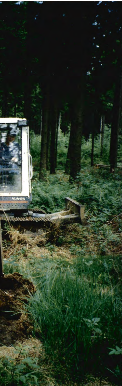
Figur 1. Gravemaskinen afkrømmer en planteplads på ca. 60x60 cm.
