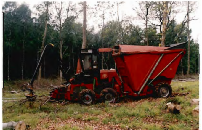
Figur 2. Silvatec flishund forsynet med kran og førerhus.
