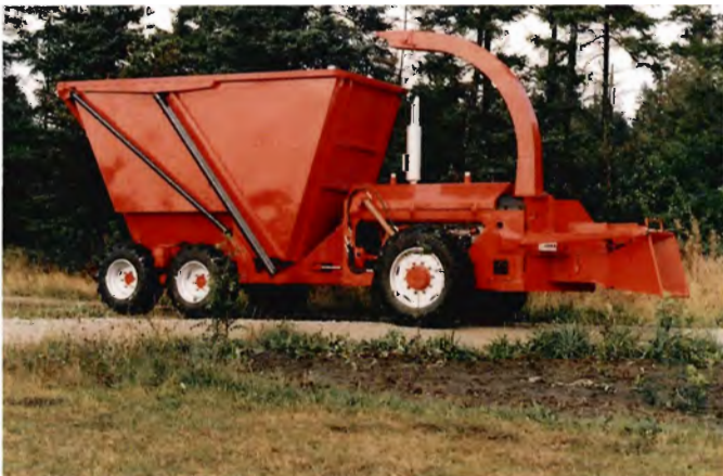
Figur 1. Den første Silvatec flishund der blev betjent fra jorden via en styrestang placeret ved siden af indmadningstragten.
