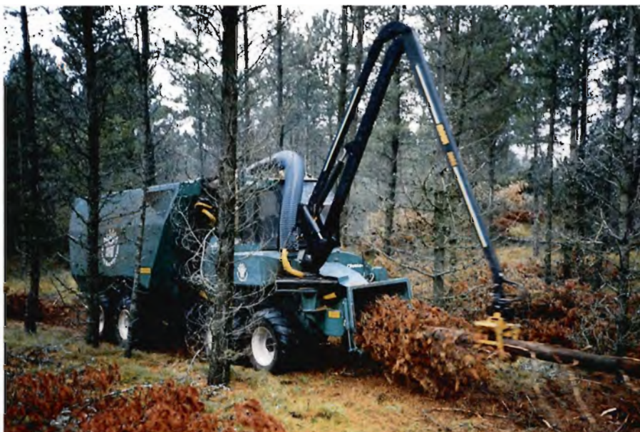
Figur 3. Silvatec CH 878 i gang med flishugning i en contortabevoksning.
