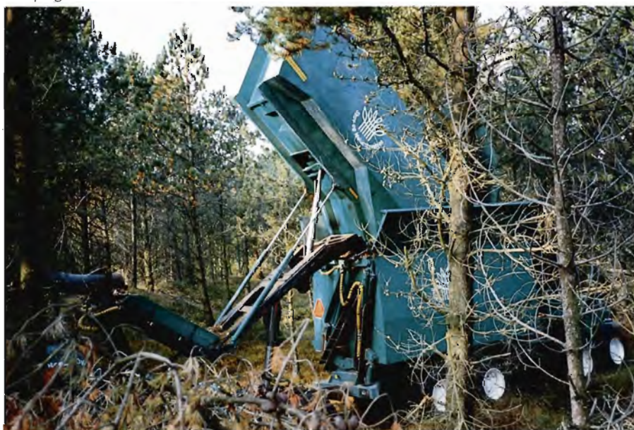
Figur 4. Silvatec CH 878 i gang med at tømme fliscontaineren over i flistransportekvipagen.
