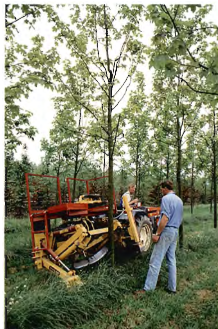
Figur 9. Planteskoler for allétræer har mange specialmaskiner. Denne rodkæremaskine bruger en krum kniv som former en halvkugleformet rodklump. Her anvendes maskinen til opretning af nyligt plantede træer. Tidligere skete omplantning manuelt med spade; det var hårdt fysisk arbejde, og man blev fristet til at lave for små rodklumper.
