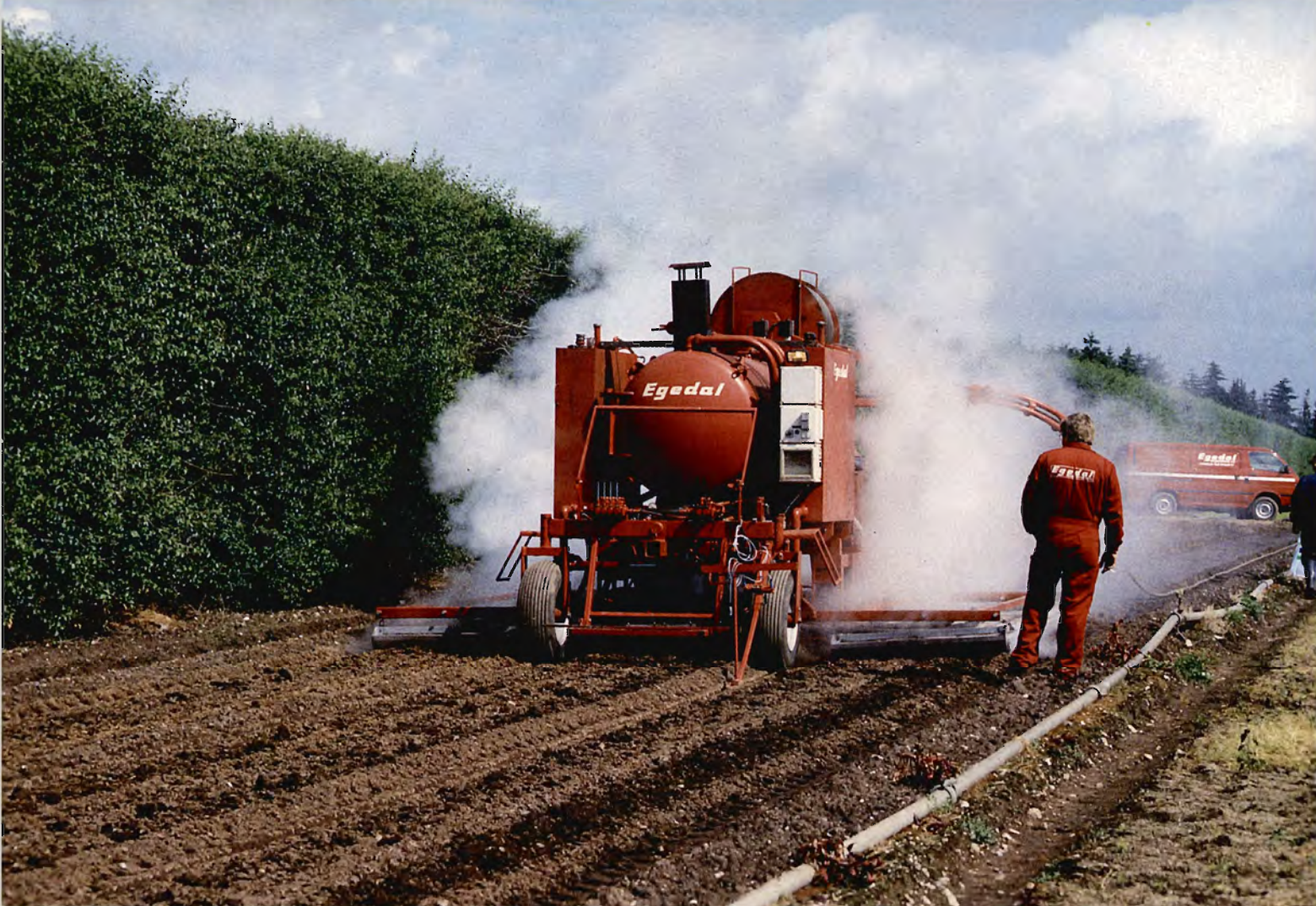
Figur 1. Udstillingens nok mest iøjnefaldende maskine - Egedal dampmaskine til desinfektion af frøbede.
