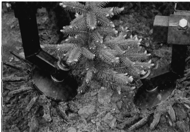
Figur 7. En tallerkenharve med gummitænder fra det tyske firma Kress & Co. Den anbefales bl.a. til renholdelse i rækkerne i juletrækulturer.
