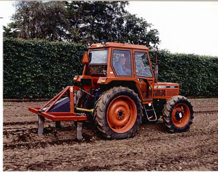
Figur 3. Mac undergrundsløser med vibrator. De vibrerende tænder betyder at der kræves mindre trækraft. Desuden sker der - efter producentens oplysninger - en løsning af jorden i hele redskabets bredde og ikke kun omkring tænderne.
