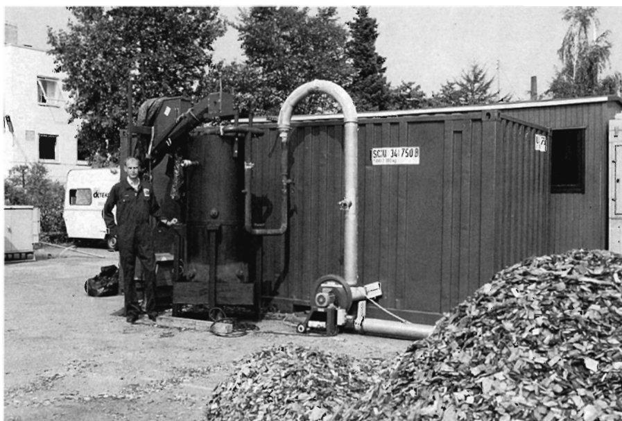
Akademiingeniør Henrik Houmann Jakobsen ved prototypen på den nye flisfyrede gasgenerator.
