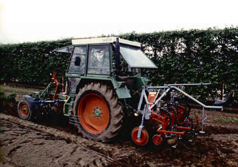
Figur 4. Specialudviklet redskabsbærer med spadeharve, fjedertandsharve og børsterensere.
