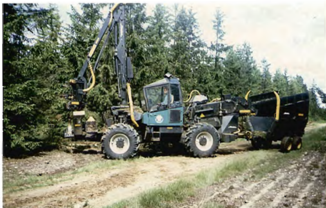
Fig. 3. Skov- og Naturstyrelsens flertræhåndterende maskine til skovning af energitræ.
