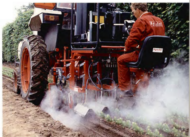
Figur 5. Egedal hedvandsrensere til fjernelse af ukrudt i priklebede - vandtanken er frontmonteret.
