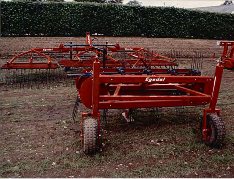
Figur 2. Redskaber til mekanisk renholdelse af nyligt fremspiset ukrudt i priklebede. I baggrunden Egedal langfingerharve, i forgrunden den nye tværrive som river på tværs af køreretningen. Begge redskaber bearbejder hele arealet og skader ikke selv nyudsprungne grønter.
